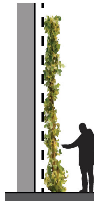
Esempio di sezione di facciata a verde indiretto
