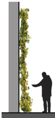
Esempio di sezione di facciata a verde diretto
