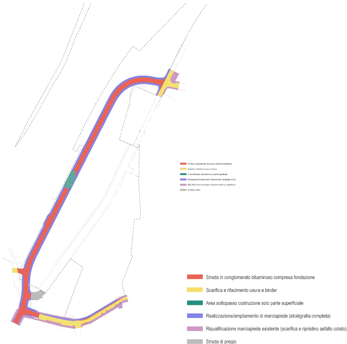
Figura 6.a – Interventi previsti sulla rete stradale
