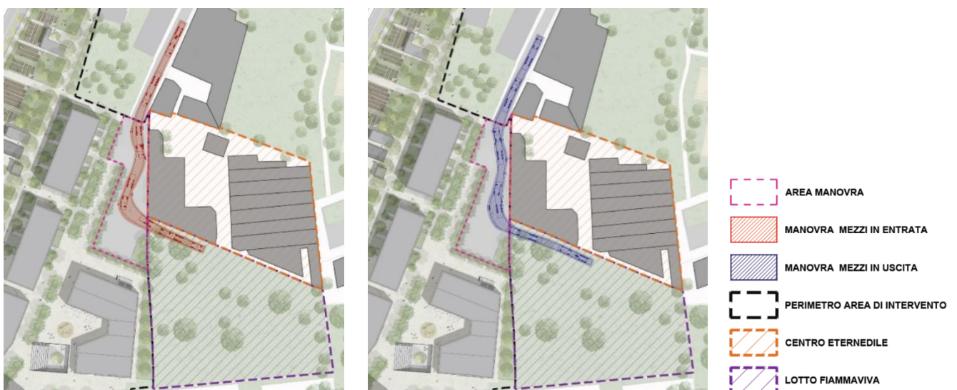
Fig. 7_ Verifica manovre Lotto Fiammaviva
