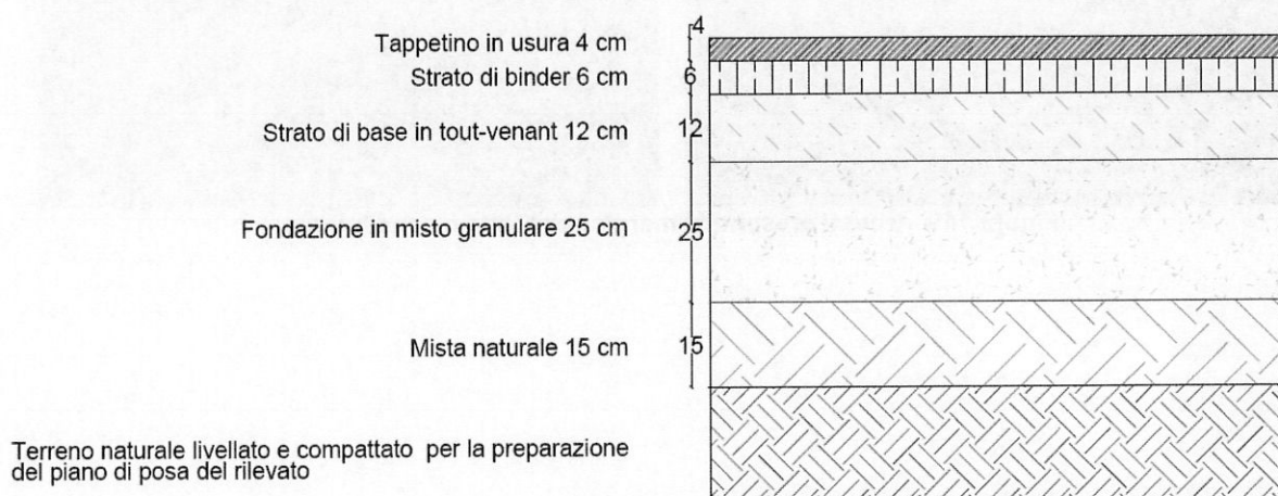
Figura 15 – Pacchetto pavimentazione stradale
