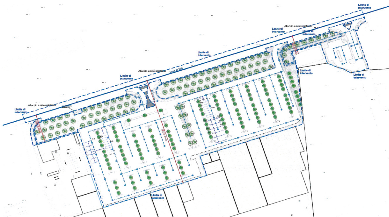
Figura 20 – planimetria smaltimento acque e fognatura nera
