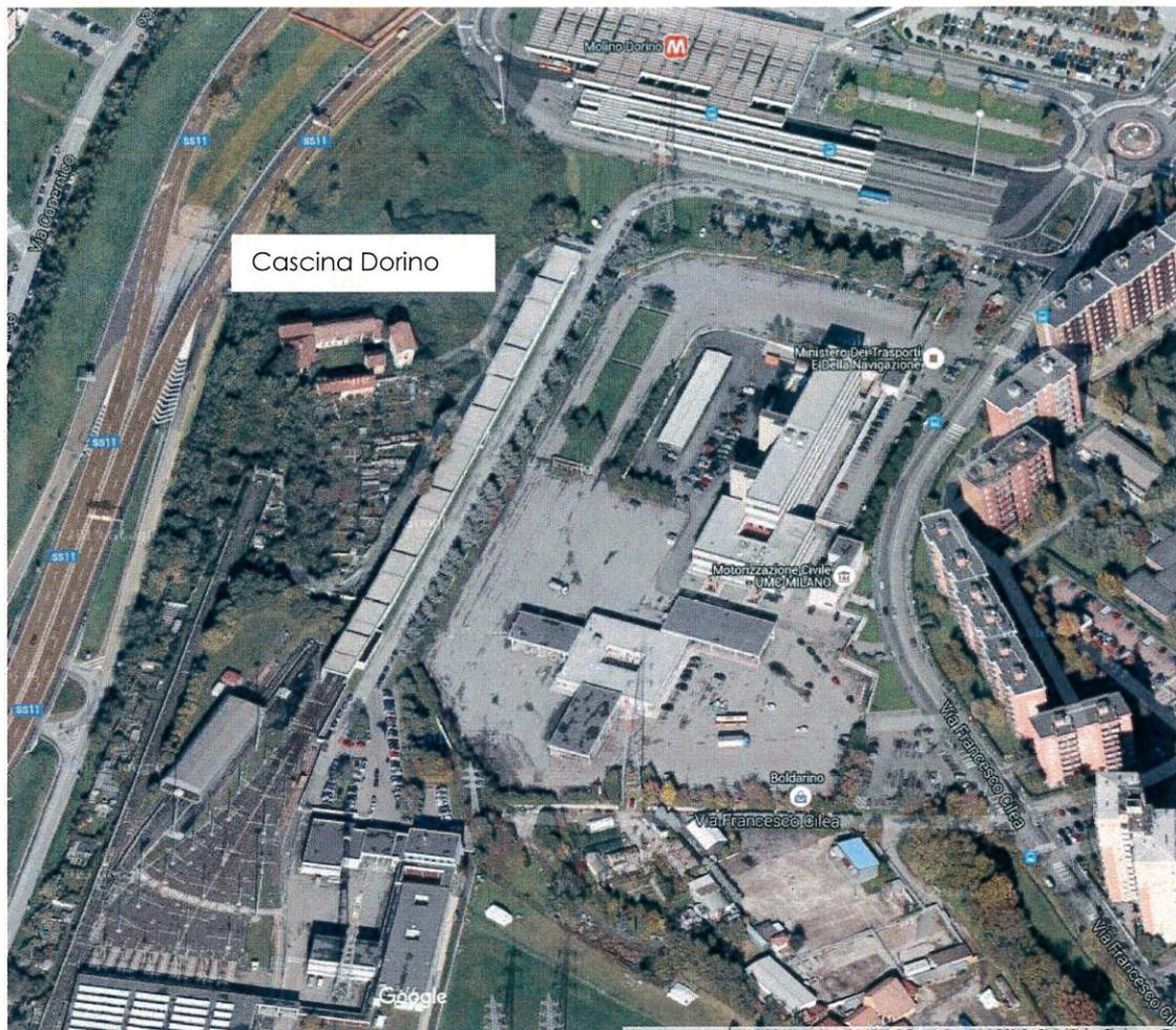
I fasci binari in ingresso alle nuove strutture da realizzare (officina e capannone di ricovero mezzi ausiliari) dovranno essere collegati alla linea attraverso un lungo binario di raccordo, che si svilupperà secondo un percorso ad anello e che, per ragioni legate a raggi di curvatura minimi e distanze di rispetto, dovrà necessariamente sconfinare su una piccola porzione del Parco Sud, un'area libera ubicata fra l'attuale deposito, e Cascina Fanetta, tutt'ora in attività.
